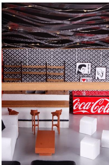
Imagen 4. Propuesta Cielos falsos a partir de la reutilización de Plástico PET.
