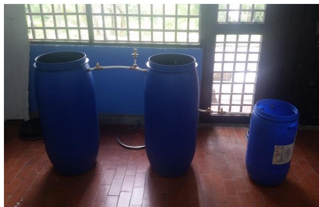
Figura 1. Montaje del Biodigestor
